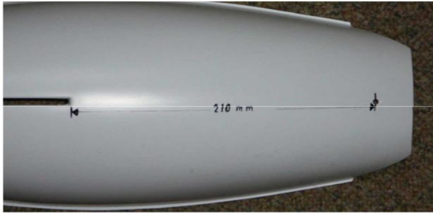
Abbildung 1: Position der Achse des Ruders
